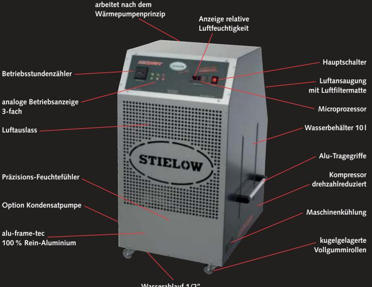
Für Hallen bis 1.200 cbm Rauminhalt. Hochleistungsluftentfeuchter mit bis zu 129 Liter Wasserentzug am Tag. Präzisionsgeregelt garantiert er das ganze Jahr eine optimale Luftfeuchtigkeit mit drehzahlherabgesetzem Kompressor, ähnlich dem Diesel eines Automotors ist er für eine extrem lange Lebensdauer ausgelegt.
